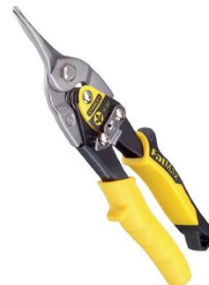
Gran efecto de palanca. Acción de corte combinada. Filos serrados para evitar el deslizamiento en el corte. Tuercas cromadas. Aleación de acero forjado (cromo-molibdeno). Placa patentada para una fácil identificación del producto. Liberación y freno automáticos. Se bloquea con una sola mano. Mangos bimetálica para mayor confort y mejor agarre. Capacidad de corte de hasta 1,2 mm. Válido para el corte de aluminio, láminas de PVC, mallas de acero, piel, cobre y plástico.
