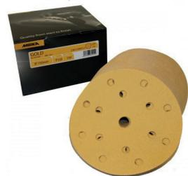
Material para el lijado duradero y general que se adapta muy bien al lijado de alta velocidad en multitud de aplicaciones. Gold presenta un grano semi-abierto y un recubrimiento especial de estearato diseñados para prevenir el embozamiento y la formación de grumos, que contribuyen a la obtención de un resultado de lijado óptimo.
