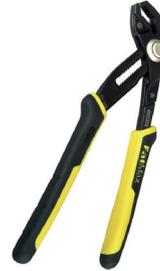
Geometría de las mandíbulas optimizada para tener varias posiciones de agarre. Botón de ajuste PushLock. Asas bimetálicas ergonómicas. Construcción por embutición. Cromo Vanadio de alta calidad. Mandíbulas endurecidas por inducción. 17 posiciones de bloqueo.
