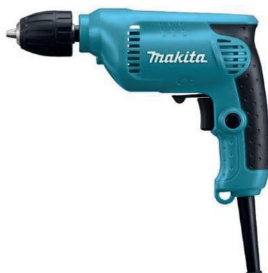
Ideal para taladros rápidos en madera o metales, especialmente aluministas hasta 10 mm. Nuevo diseño de la herramienta equilibrado y extremadamente manejable. Empuñadura antideslizante con elastómero. Con velocidad variable para iniciar los taladros con precisión. Portabrocas automático 10 mm. Interruptor más grande, fácil de accionar con dos dedos y reversible. y con posibilidad de bloqueo. Práctico soporte para colgar.
