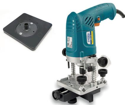
Diseñada para la realización de encajes para la posterior colocación de pernios o bisagras sin usar plantillas. Incorpora regulación milimétrica para una fácil regulación. También permite el perfilado de cantos en piezas canteadas y el fresado de ranuras en madera o materiales plásticos. Incluye de origen una base accesoria con copiador para fresar copiando usando plantillas.
