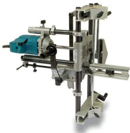
Diseñada especialmente para la realización de cajeados en puertas u otros elementos con gran rapidez y precisión; en la obra o en el taller. Su especial sistema de fijación permite realizar cajeados en las puertas ya colgadas sin dañar su superficie. Ajuste de medidas rápido el cual permite la realización de múltiples cajeados en un tiempo record.
