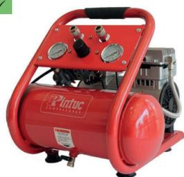
Compresor portátil con cabezal silencioso y exento de aceite, con un diseño compacto y con centro de gravedad muy bajo. Pensado para uso doméstico o para aplicaciones que precisen caudal bajo y discontinuo, por ejemplo alimentación de clavadoras o grapadoras neumáticas. Incluye doble manómetro (presión del depósito y presión de salida), y dos enchufes rápidos de salida de aire. 65 dB
