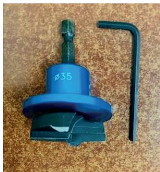
Broca ideal para hacer taladro y colocar bisagras en la reparaciones de puertas de cocina o hacer taladros con limitación de profundidad del taladro por ejemplo: si se repara una puerta en el domicilio de un particular o en el propio taller, nos da la seguridad de no traspasar la puerta.
